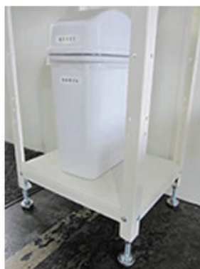
モップなどで掃除がしやすいように、棚などの脚には部品を取り付け底上げしています
