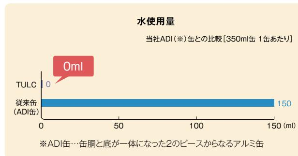
製缶時に発生する固形廃棄物は、潤滑剤を使って成形した缶の場合、潤滑剤を洗い流した水を処理するプロセスで最も多く発生します。TULCは製缶時に潤滑剤を使わないので、固形廃棄物量を大幅に削減できました。
