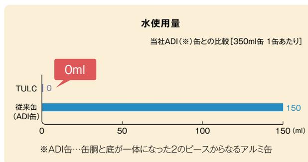
製缶時に発生する固形廃棄物は、潤滑剤を使って成形した缶の場合、潤滑剤を洗い流した水を処理するプロセスで最も多く発生します。TULCは製缶時に潤滑剤を使わないため、固形廃棄物量を大幅に削減できました。
