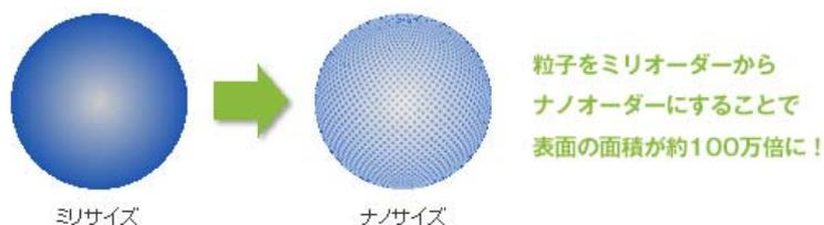
ナノファス銀タイプは、プラスチック樹脂中に銀ナノ粒子を均一分散させた機能性材料です。成形品の表面は銀の抗菌作用により、細菌の増殖が抑制され、同時に細菌由来の悪臭発生を防止することができます。
